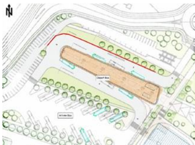
Figure 7 : emplacement des dispositifs de protection des habitations contre le bruit des bus (l'écran est représenté avec une ligne rouge et le préau est en orange) (source : annexes de l'étude d'impact)
