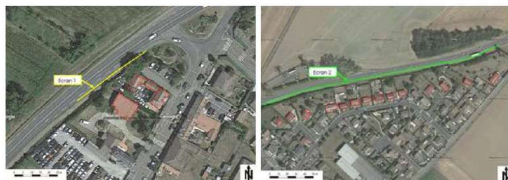
Figure 9 : protections par écrans acoustiques pour les bâtiments hors périmètre réglementé du PGS (source : dossier)
