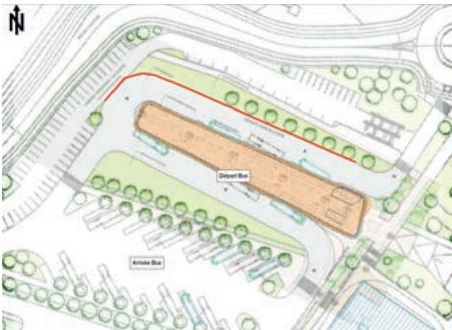
Afin de protéger les habitations situées au nord et à l'ouest de la gare routière, le projet a intégré la mise en œuvre d'un écran acoustique en bordure de cette future infrastructure, d'une hauteur de 2,8 m de haut et de 104 m de long. Il respectera les préconisations d'affaiblissement acoustique issus de l'étude. La sous face du préau abritant les quais au départ, sera équipée d'un faux plafond acoustique absorbant.
